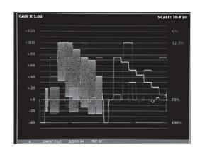
波形モニターは縦軸を信号レベル、横軸を時間として映像信号の波形を表示する測定器である。コンポジット方式の映像信号の明度は、レベルが高ければ( a )、低ければ( b )映像であると判断できる。同様に彩度も、レベル幅が広ければ色が( c )、狭ければ色が( d )映像であると判断できる。ただし、波形モニターでは( e )を測定することができないため、一般的にはベクトルスコープと併用して信号管理を行う。
